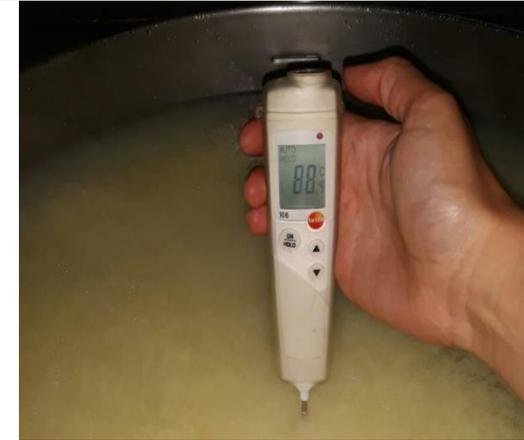
Prélèvement des Température par un thermomètre à sonde étalonné
